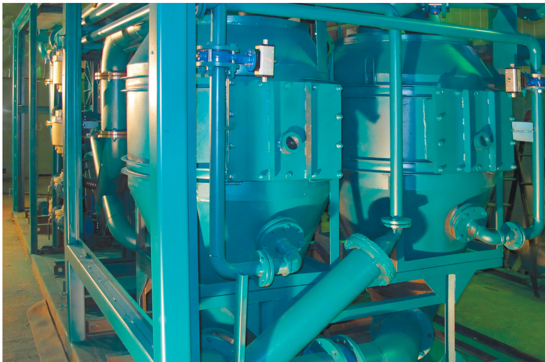
Осадительные камеры пневмовакuumного разгрузчика – серийные пневмокамерные насосы производства НПК «МЕТАЛТЕК»
