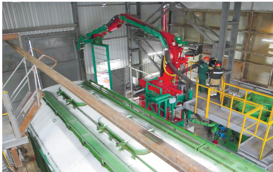
Пневмовакuumный разгрузчик с гидроманипулятором для верхней выгрузки производства НПК «МЕТАЛТЕК»
