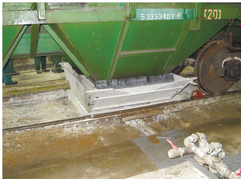
Приемное устройство лоткового типа для нижней выгрузки хопперов и минераловозов производства НПК «МЕТАЛТЕК»
